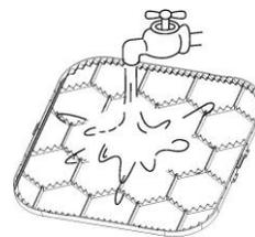
En cas d'utilisation d'eau, le côté de l'entrée doit être orienté vers le bas et à l'opposé du jet d'eau. écoulement d'eau.
