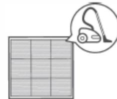
Si utiliza una aspiradora, el lado de la entrada debe estar de frente a la aspiradora.
